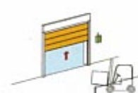
apertura con fotocellule Ir
